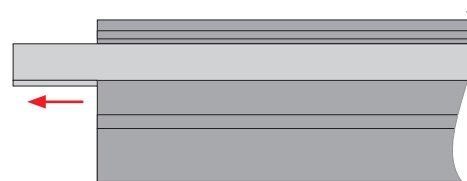
Рис. 1. Извлечение экрана Ⓜ из профиля Ⓜ , вид сверху
