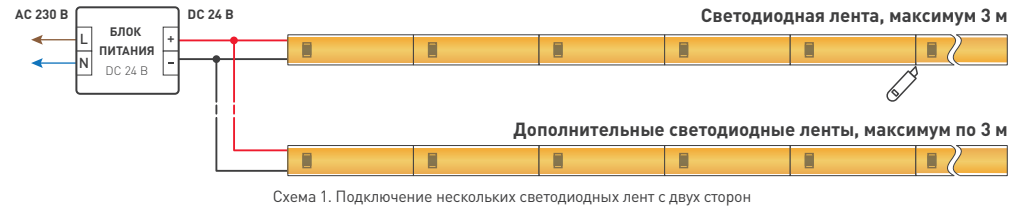
Схема 1. Подключение нескольких светодиодных лент с двух сторон
