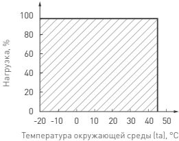
Рис. 3. Максимальная допустимая нагрузка, % от мощности источника
