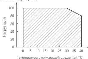
Рис. 1. Максимальная допустимая нагрузка, % от мощности источника
