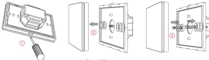
Рисунок 3. Монтаж панели
