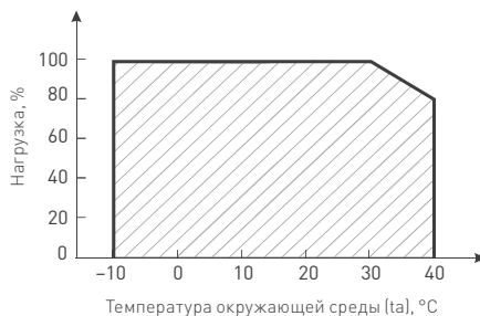
Рис. 2. Максимальная допустимая нагрузка, % от мощности источника
