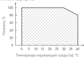
Рис. 1. Максимальная допустимая нагрузка, % от мощности источника
