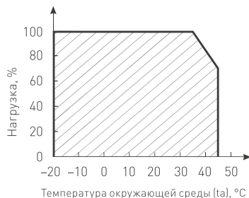
Рис. 2. Максимальная допустимая нагрузка, % от мощности источника
